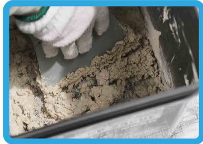
ヘラでかき混ぜていくとすぐに固化していきのわかります。
